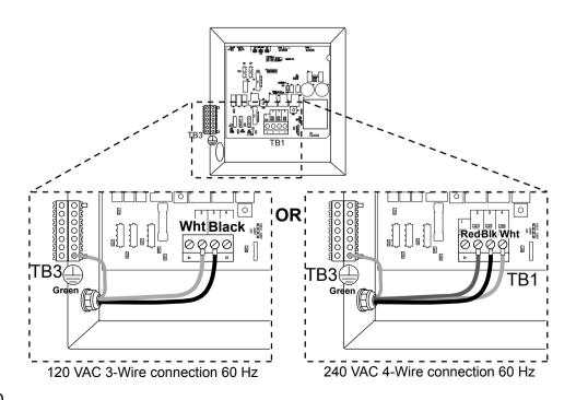
Installing a 3-Wire 120 VAC or 4-Wire 120/240 VAC Connection for: 780 Dover<sup>™</sup> Models, 680 Denali<sup>®</sup>, Tacoma<sup>®</sup>, Prado<sup>™</sup>, Prado<sup>™</sup> Models
